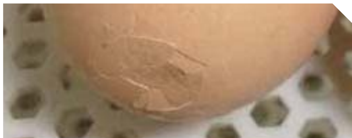
卵リフターの過剰な真空圧により、卵の鈍端にダメージ。
