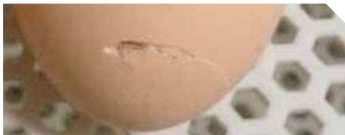
ハンドリング装置についた突起物や横棒によって起こるダメージ。
