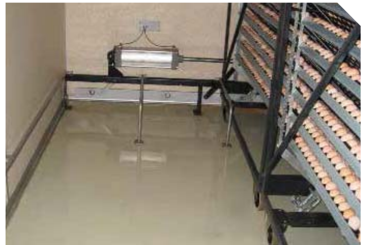
密閉期間の終了時のシングルセッターの床の水たまり。
