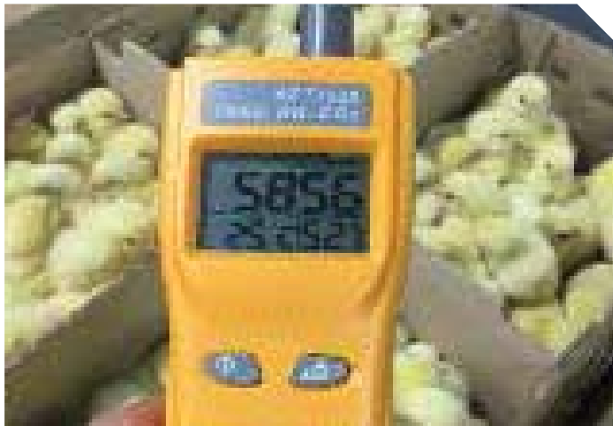
換気が不十分なヒナ保管室で測定された高CO 2 レベル。
